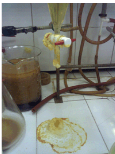
Негерметичный кран воронки – частая причина неприятностей (автор Гвоздь А.Н.)
