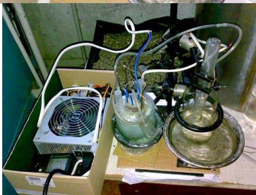
Самодельная установка для электролиза \text{NaCl} и наблюдения горения водорода в хлоре (автор VadMat).
